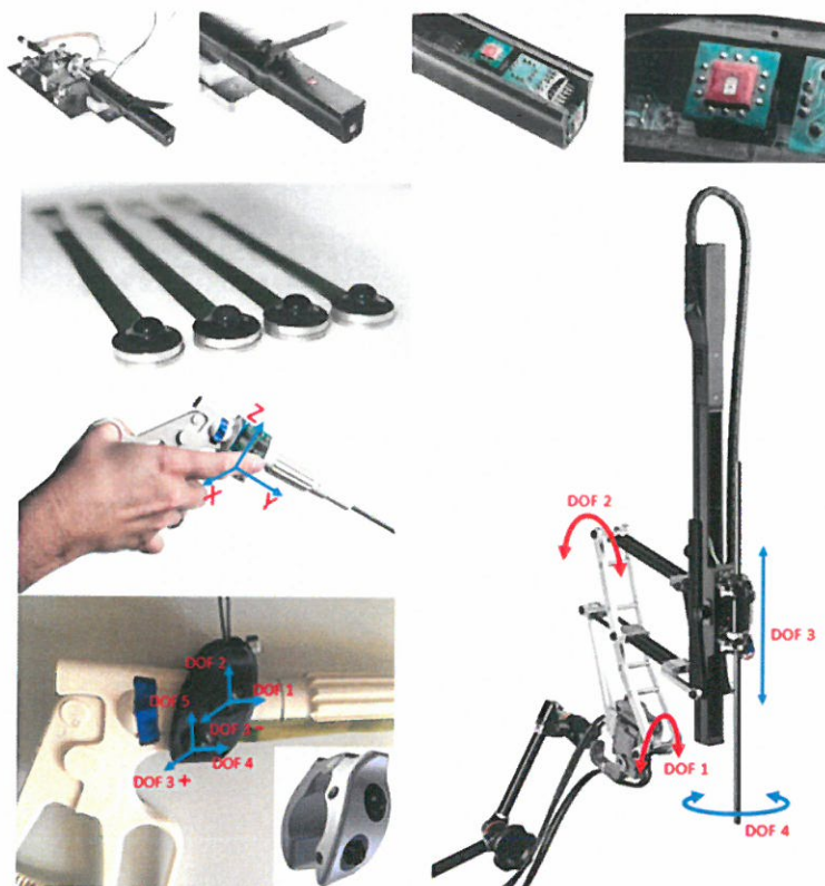
Elementy czujnika siły oraz integracja z systemem sterowania robota Robin Heart
